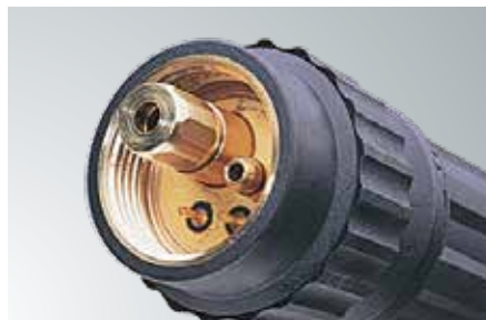
Standard Euro-Zentralanschluss, keine zusätzlichen Steuerleitungen sind erforderlich.
